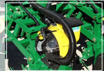
Opcional: Dosificador Neumático Precision Planting vSet con motor eléctrico vDrive.
