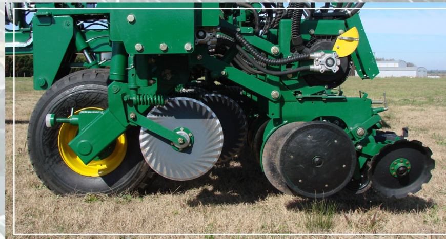
Cuerpo Plantador: Sistema Filam - Disco doble centrado de estampado cónico y filo interno. Montados al chasis por medio de paralelogramos.
